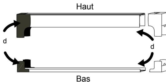
**e** - Mettre les embouts sur la barre de manœuvre.
